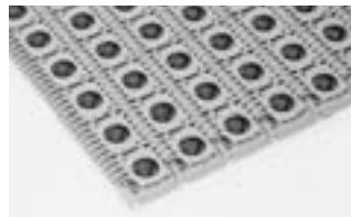
SÉRIE 400 ROLETES EM ÂNGULO DE 45°/60° • Acionamento central • Articulação fechada • Passo de 2,00 pol (50,8 mm)
