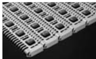
SÉRIE 400 ROLLER TOP TRANSVERSAL - 0,85 pol • Acionamento central • Articulação fechada • Passo de 2,00 pol (50,8 mm)
