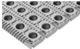
SÉRIE 400 ROLETES EM ÂNGULO DE 90° • Acionamento central • Articulação fechada • Passo de 2,00 pol (50,8 mm)
