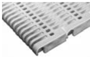
SÉRIE 400 • Acionamento central • Articulação fechada • Passo de 2,00 pol (50,8 mm)
