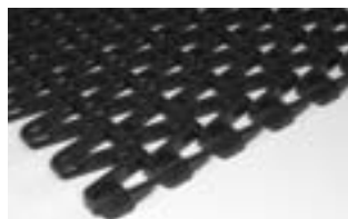
SÉRIE 2600 (1.0) • Acionamento pela articulação • Articulação aberta • Em curva • Passo de 2,00 pol (50,8 mm)
