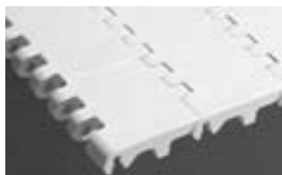
SÉRIE 1800 • Acionamento central • Articulação aberta • Passo de 2,50 pol (63,5 mm)
