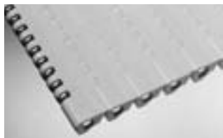
SÉRIE 1100 • Acionamento pela articulação • Articulação aberta • Passo de 0,60 pol (15,2 mm)
