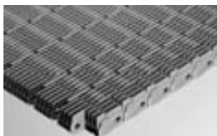
SÉRIE 1900 • Acionamento central/pela articulação • Articulação fechada • Passo de 2,07 pol (52,6 mm)
