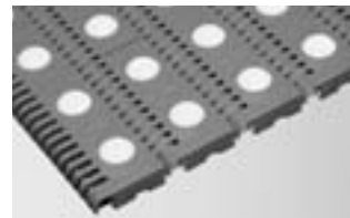
SÉRIE 400 BALL (com esferas) • Acionamento central • Articulação fechada • Passo de 2,00 pol (50,8 mm)
