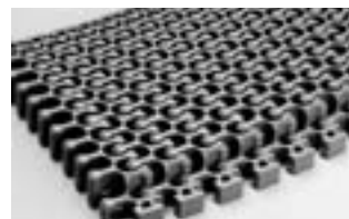
SÉRIE 2200 HIGH DECK • Acionamento pela articulação • Articulação aberta • Em curva • Passo de 1,50 pol (38,1 mm)
