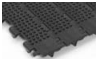
SÉRIE 850 MINIMUM HINGE NUB TOP • Acionamento central • Articulação aberta • Passo de 2,00 pol (50,8 mm) • Borda lisa
