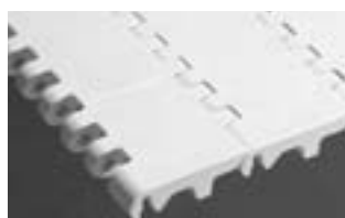
SÉRIE 1800 • Acionamento central • Articulação aberta • Passo de 2,50 pol (63,5 mm) • Borda lisa
