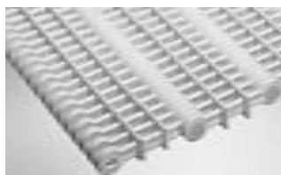
SÉRIE 200 • Acionamento pela articulação • Articulação fechada • Passo de 2,00 pol (50,8 mm) • Borda irregular
