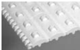
SÉRIE 800 ROLLER TOP • Acionamento central • Articulação aberta • Passo de 2,00 pol (50,8 mm)
