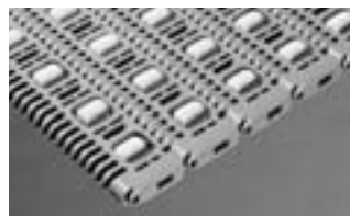
SÉRIE 400 ROLLER TOP TRANSVERSAL • Acionamento central • Articulação fechada • Passo de 2,00 pol (50,8 mm)
