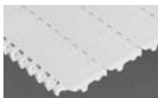
SÉRIE 800 • Acionamento central • Articulação aberta • Passo de 2,00 pol (50,8 mm) • Borda lisa
