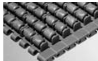
SÉRIE 1400 ROLLER TOP • Acionamento central/pela articulação • Articulação fechada • Passo de 1,00 pol (25,4 mm)
