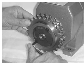
Apertar os parafusos Alternadamente
