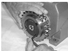
Removendo uma bucha Taper-Lock®
